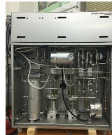
メタンガス分解装置
