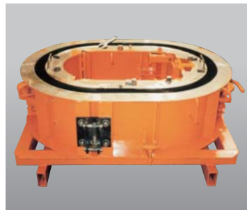
下水用マンホール型枠
