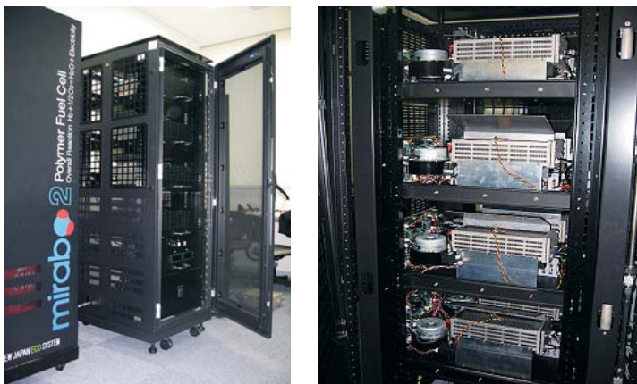
ラック式定置型燃料電池(日大工学部導入)
